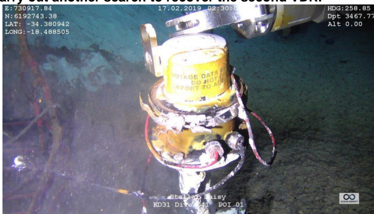
Recovery of the Stellar Daisy 's VDR: latitude -34.380942, longitude -18.488505, depth 3467.77 m © Ocean Infinity
