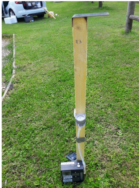
Photo 1: Prélèvement des retombées atmosphérique à l'aide de plaquette de dépôts et évaluation du ré-envol de poussière à l'aide d'un filtre à particule.
