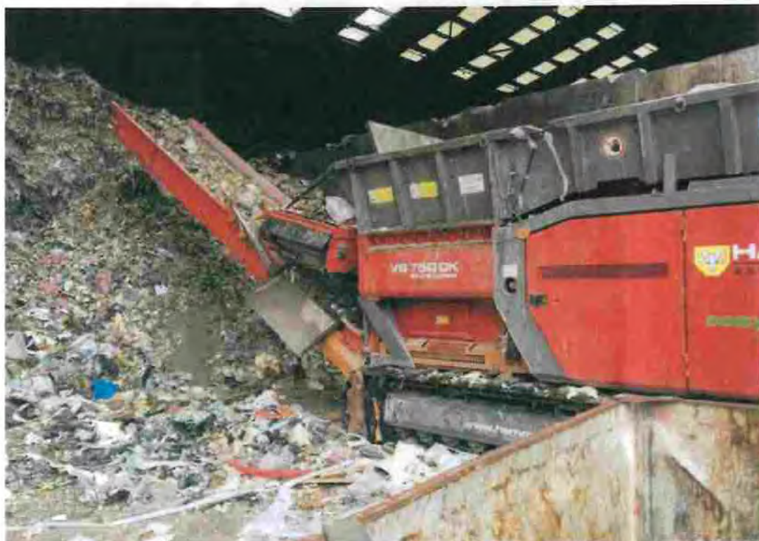
Photo 1 du 28 janvier 2021 – Broyage de déchets en cours
