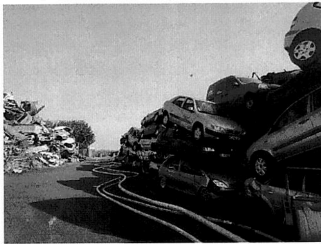
Empilement des VHU non dépollués (sans roues) et mélangés avec des VHU dépollués
