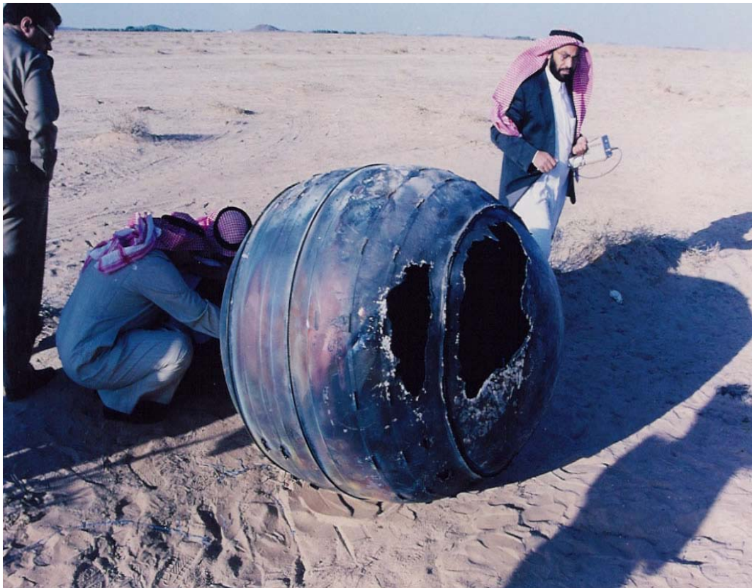
Cuve en titane d'environ 50 kg provenant du troisième étage d'un lanceur Delta 2, retombée le 21 janvier 2001 en Arabie Saoudite après huit années en orbite.
