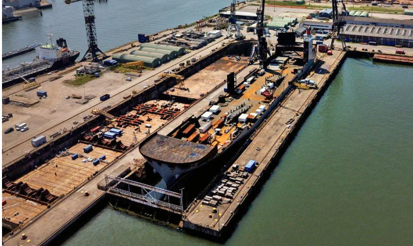
Le Fremantle Highway , août 2024, après découpe des ponts supérieurs. © Olivier Middendorp
